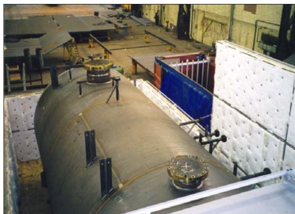
De lading van de oven bestaat hier uit een ketel met een gewicht van ca. 8000 kg die spanningsarm gegloeid moet worden op 600°C.
